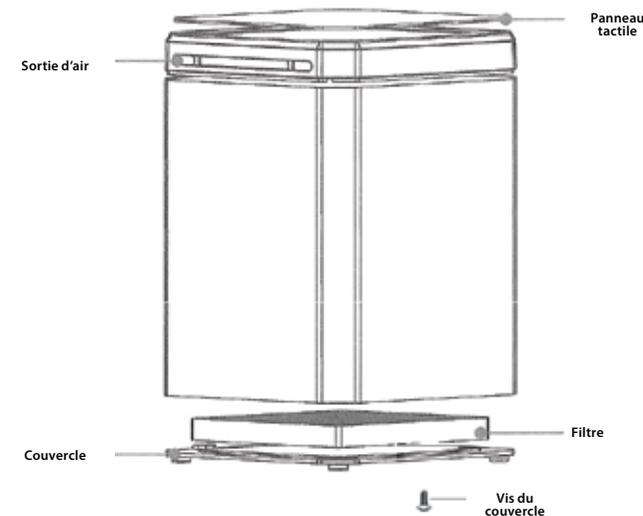
REMARQUE : Serrez les vis du couvercle après avoir remplacé le filtre.
